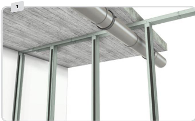
Alle Module einfügen. In den meisten Fällen werden die Rohre zwischen den Ständern verlegt, und Sie können die horizontalen Profile über den Rohren an der Decke befestigen.
