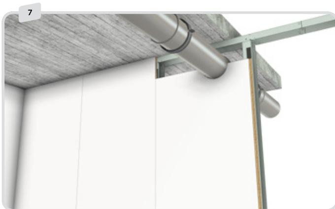
Ohne das Rohr könnte sich die Platte drehen und in die 2. Platte einrasten. Das Rohr verhindert diese Bewegung.
