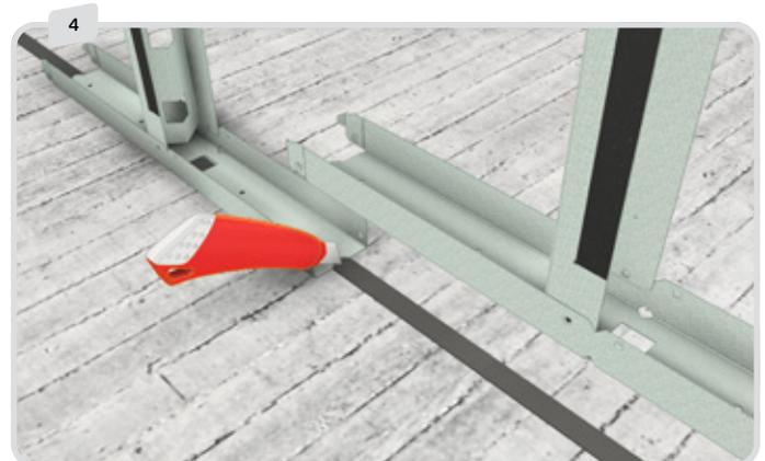
Um es später leicht demontieren zu können, empfiehlt es sich, das Band an der Verbindungsstelle der einzelnen Module zu durchtrennen.
