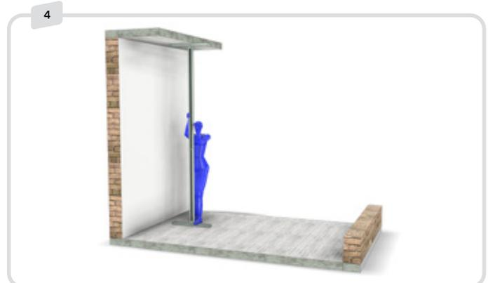
Das Modul zwischen Boden und Decke klemmen, mit Quickspan schliessen.
