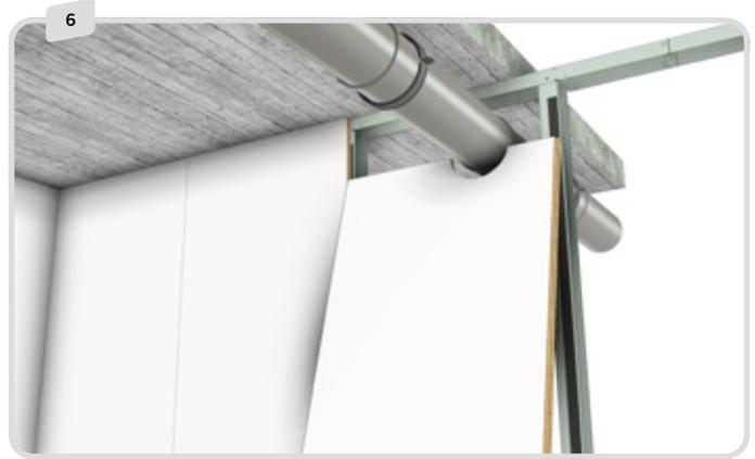
Ab der 3. Platte einen Ausschnitt für das Rohr mit einer Toleranz von 3 mm anfertigen. Bringen Sie es von unten an, aber drücken Sie es noch nicht gegen das Band des I-Moduls.
