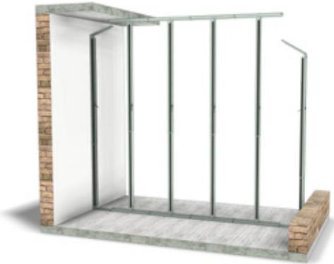
Entfernen Sie den Laser und befestigen Sie die C-Module.
