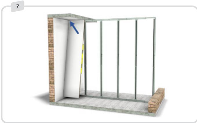
Montieren Sie die erste Platte an der linken Wand und an der Decke. Drücken Sie die Platte noch nicht gegen das JUUNOO-Band.
