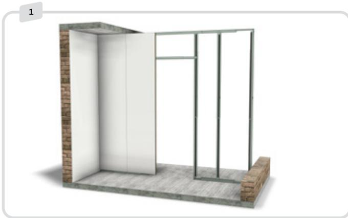
Markieren Sie die Türöffnung auf der Rückseite der Platten. Klicken Sie die Platte aus dem System aus und sägen die überschüssigen Teile ab. Achten Sie darauf, dass zwischen der Platte und dem Türrahmen ein kleiner Spalt bleibt (siehe Seite 46, Bild 6).
