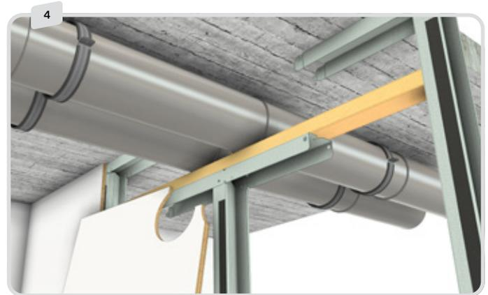
Machen Sie einen Ausschnitt in der Platte. Schneiden Sie wieder einen Streifen vom Verbindungsprofil ab. Wie oben beschrieben vorgehen. Zum Schluss schieben Sie die Platte nach links, um sie zu verriegeln.
