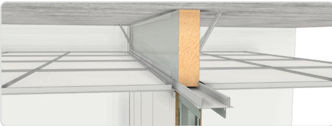
Als Alternative kann die Zwischendecke auch nach dem Einbau der JUUNOO-Wand montiert werden. Dies ist eine robustere Struktur, die jedoch weniger leicht anzupassen ist.
