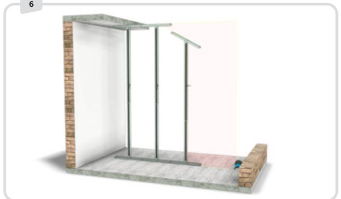
Setzen Sie dies mithilfe von I-Modulen an der gesamten Wand fort.
