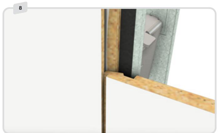
Dank der ausgeschnittenen Nut kann die Feder der 3. Platte seitlich in die 2. Platte gleiten. Dies erfordert einen Freiraum von 3 mm um das Rohr selbst.
