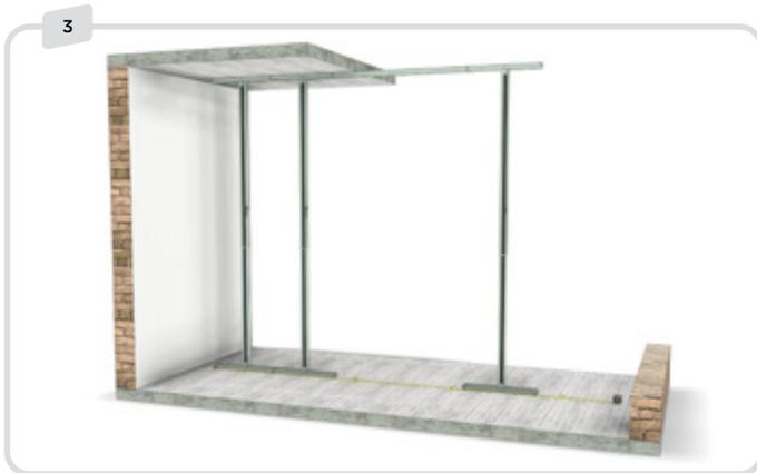
Setzen Sie die I-Module ein. Setzen Sie an der Stelle der Türöffnung ein Tür-Oberprofil ein.
