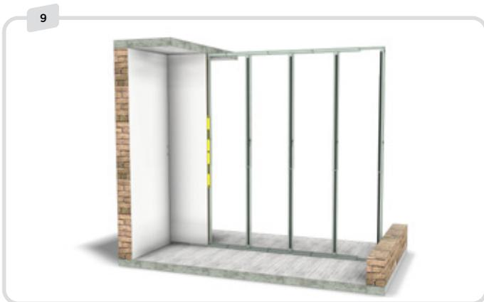
Die Platten werden nicht direkt auf dem Boden verlegt, um mögliche Probleme mit aufsteigender Feuchtigkeit zu vermeiden. Sobald die Platte waagrecht ist, drücken Sie sie fest an.
