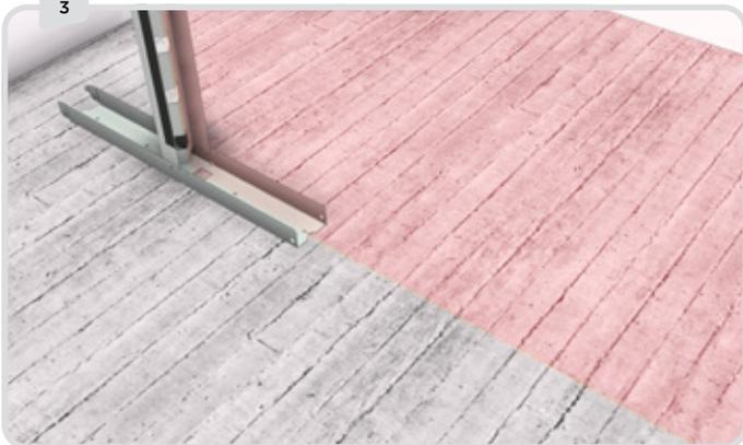
Zentrieren Sie das horizontale und vertikale Profil entlang dem Laserstrahl. Befestigen Sie dieses Modul.
