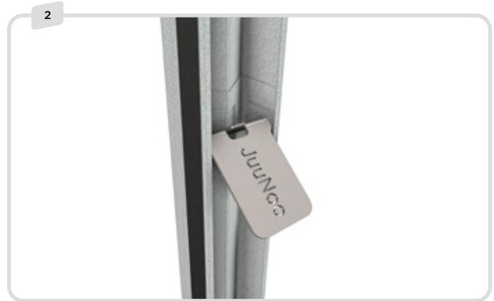
Der Quickspan wirkt wie ein Hebel, damit Sie reibungslos arbeiten können. Le Quickspan agit comme un levier pour vous permettre de travailler en toute fluidité.
