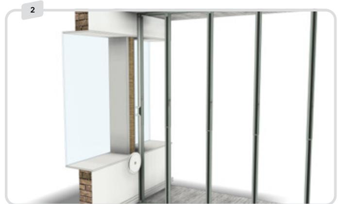
Befestigen Sie eine Holzleiste am Fenster, um die Platte zu stützen.
