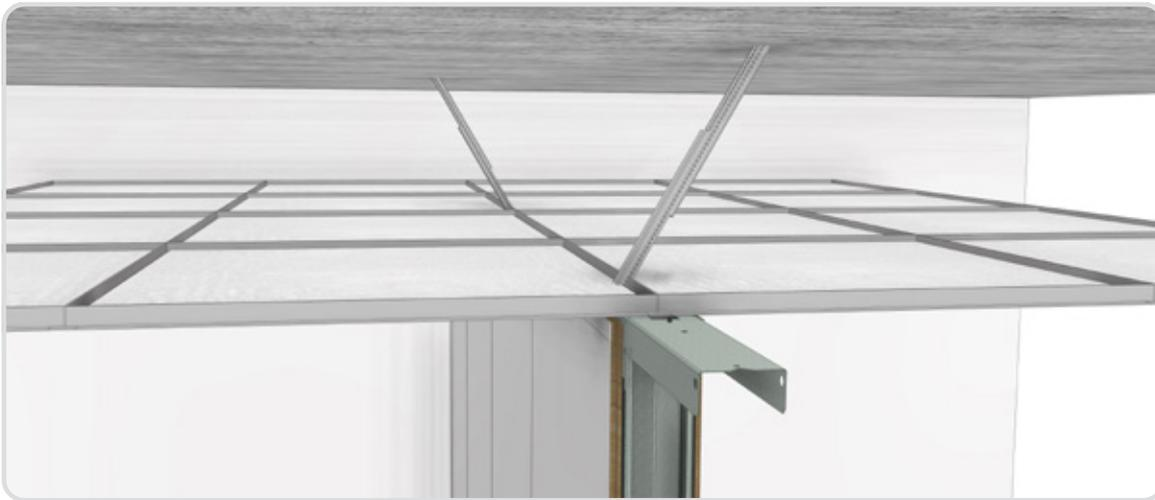
Wenn die Wand nicht auf einem Profil der abgehängten Decke platziert werden soll, kann zunächst eine Holzplatte an der Decke befestigt werden, an der dann alle Module angebracht werden.
