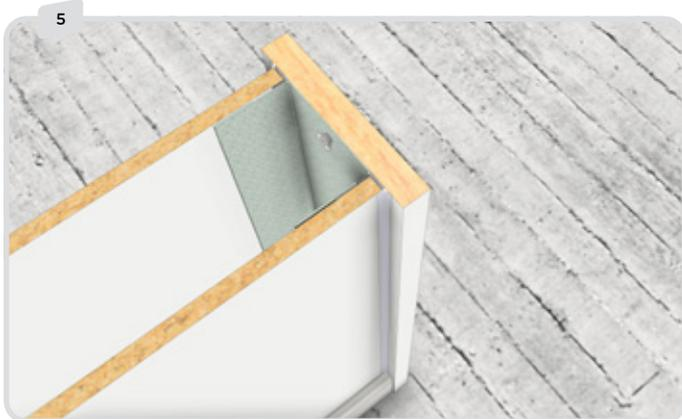
Dichten Sie die Verbindung zwischen Platte und Abschlussleiste mit Sanitärsilikon ab.
