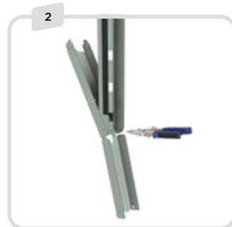
Schneiden Sie die erhöhten Kanten des horizontalen Profils an der angegebenen Markierung ab.
