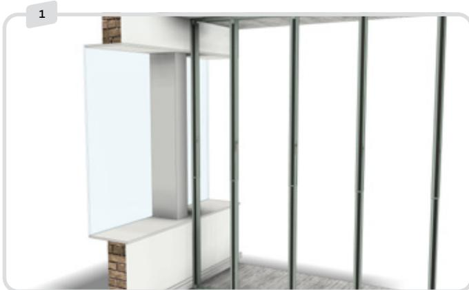
Befestigen Sie das C-Modul so nah wie möglich am Fenster.
