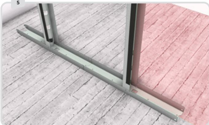
Lassen Sie die Module einrasten, zentrieren und befestigen Sie das Ende in einer Linie entlang dem Laserstrahl.
