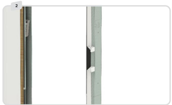
Bringen Sie das JUUNOO-Band an den Pfosten der Tür an und klappen Sie die Schutzfolie zurück.
