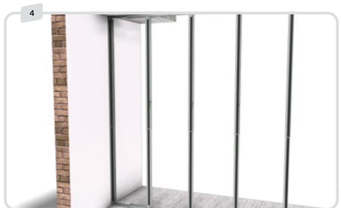
Lassen Sie das C-Modul oben in das I-Modul einrasten und fixieren Sie es.
