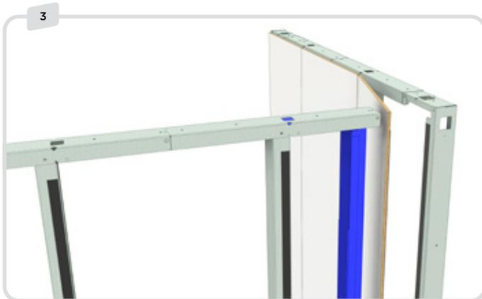
Montieren Sie die Platten an die erste Modulstruktur.
