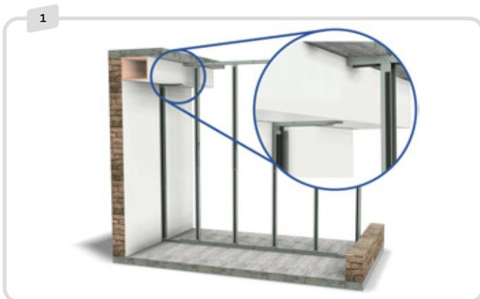
Befestigen Sie das C-Modul unter der Aussparung. Stellen Sie sicher, dass das I-Modul eben ist. Möglicherweise müssen Sie ein Stück davon abschneiden.
