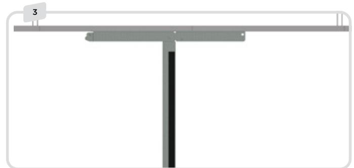
Das Modul endet knapp unterhalb der abgehängten Decke. Die abgehängte Decke wird nicht nach oben gedrückt. Befestigung mit einer selbstschneidenden Schraube.
