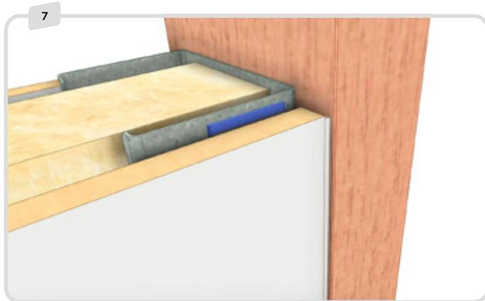
Bei einer Blocktür wird die Fuge mit einer Dichtungsmasse abgedichtet.
