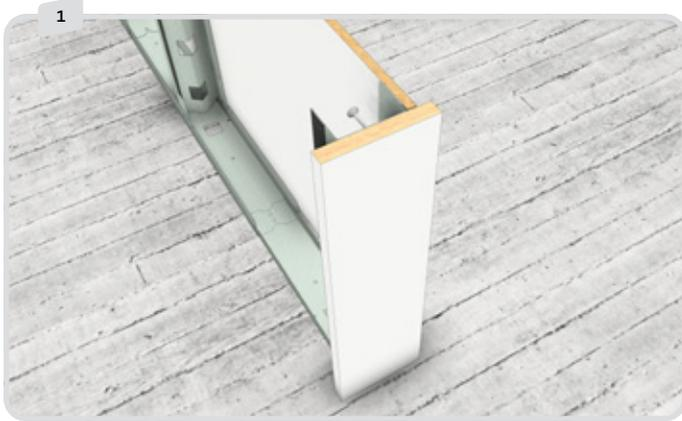
Lassen Sie mindestens eine Seite der Modulstruktur offen, damit die Abschlussleiste an der Innenseite der Struktur befestigt werden kann.
