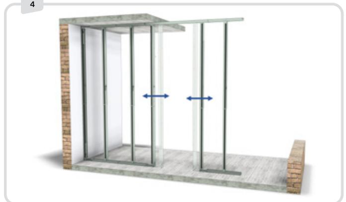
Die Platzierung der C-Module/Breite der Türöffnung kann angepasst werden.
