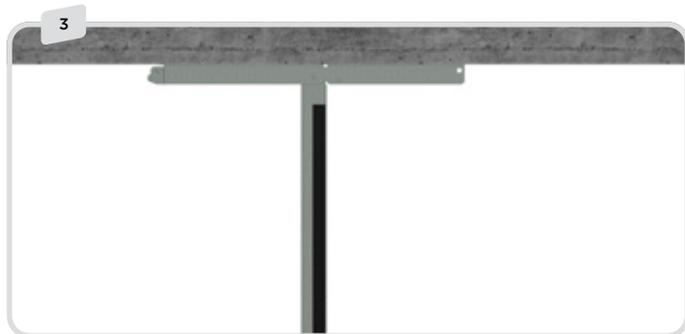
Das Modul wird gegen die Decke gespannt.
