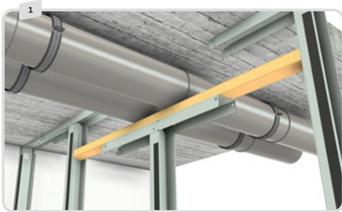
Montieren Sie eine Holzleiste unter die Rohre und zwischen die I-Module links und rechts des mittleren Moduls.
