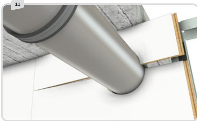
Schieben Sie die Platte in die Nut der linken Platte, bevor Sie das Band andrücken.
