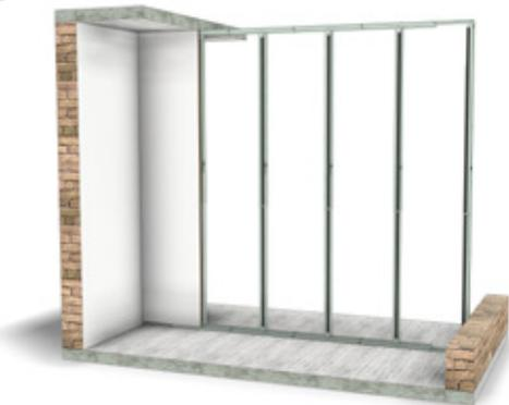
Sägen Sie die erste Platte auf die richtige Größe zu und befestigen Sie sie genau senkrecht auf den Modulen.
