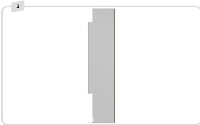
Schneiden Sie die Kontur der Fensterbank und der Rohre aus der Platte aus, gemessen vom ersten I-Modul.
