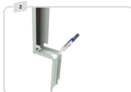
Falten Sie das Profilstück um und schneiden Sie die untere Kante ab.
