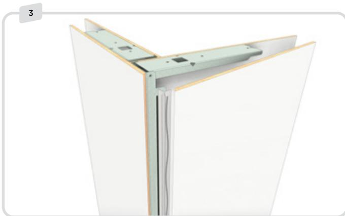
Tragen Sie das Dichtmittel auf die «Schenkel» des Eckprofils auf, wo es Kontakt mit der Platte hat. Das Profil muss nicht mit dem C-Modul verklebt werden.
